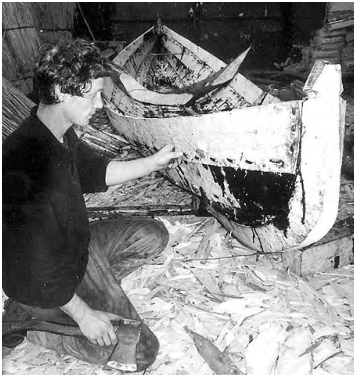
Misha Naimark bygger i Fotevikens Museums regi en båt genom att sy samman bordsplankorna med rottrådar enligt gammal teknik, hämtad från nordvästra Ryssland. På liknande sätt har man under hela vår forntid sammanfogat skeppsdelar.
